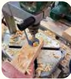
Mit dem Forstnerbohrer die Vertiefungen fräsen
